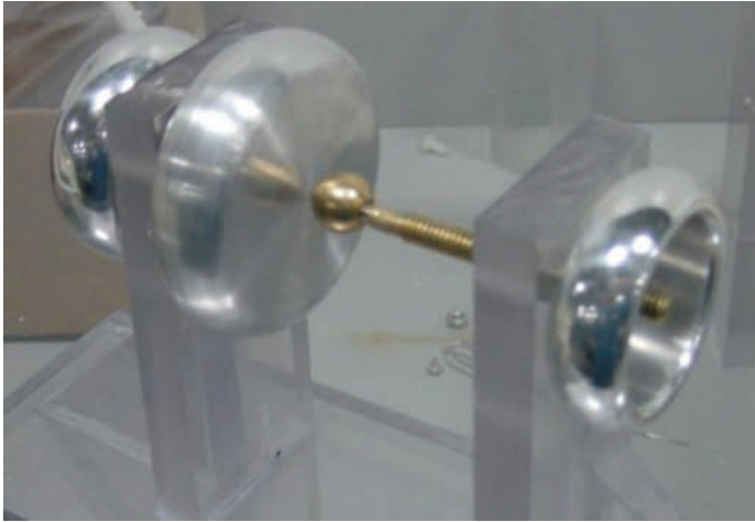
Рисунок 3. Искровой промежуток плоскость — сфера
