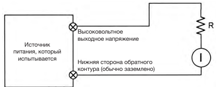
Рис. 2. Схема испытания при постоянной нагрузке
