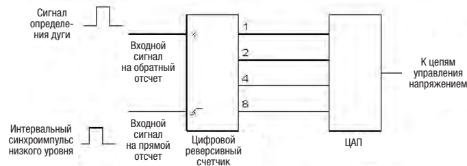
Рис. 6. Схема автоматического снижения напряжения
