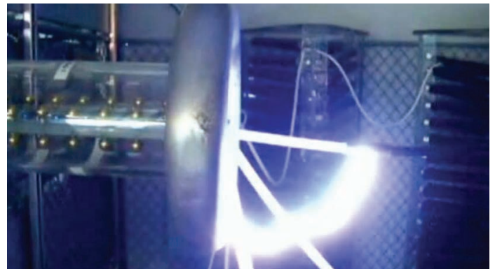
Рисунок 9. CUT#4. Фотография поверхностного перекрытия. Положительная полярность
