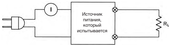
Рис. 11. Измерение входного переменного тока
